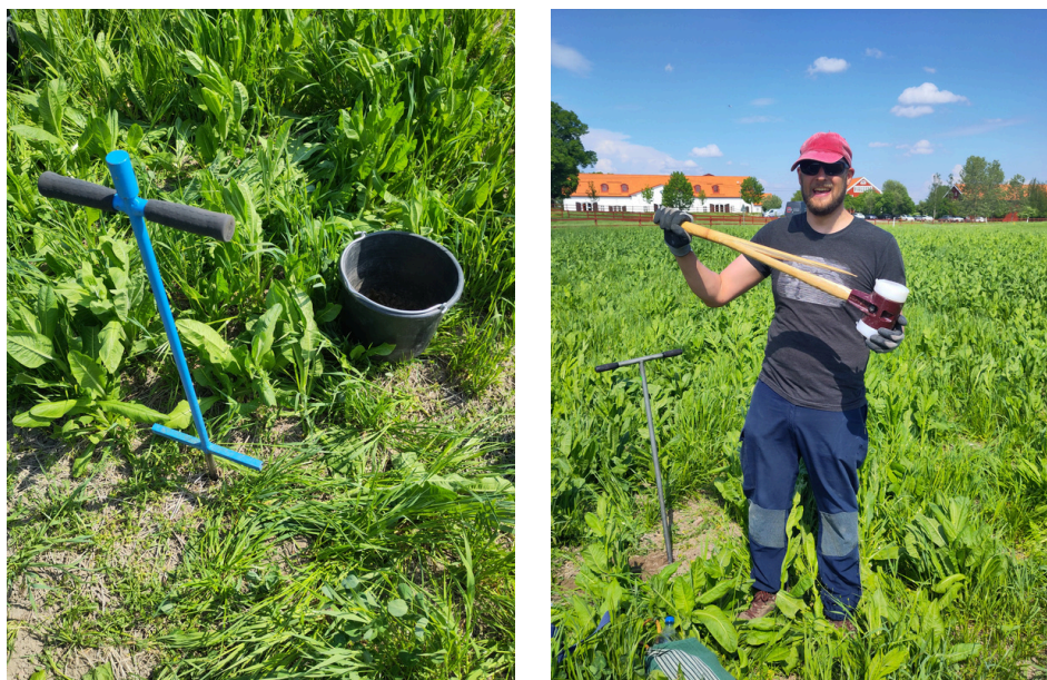
Figur 7 och 8: Provtagning på Torsåker gård ner till 90 cm djup.
